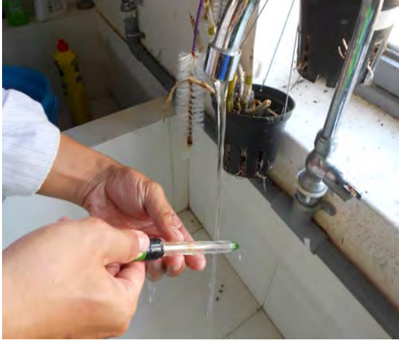
Hình 1.2.24. Rửa điện cực
