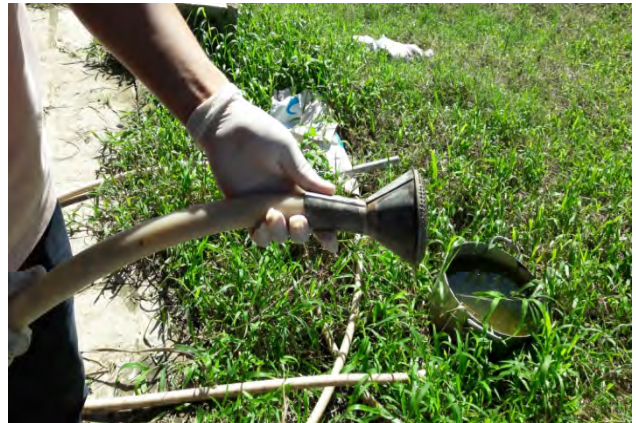
Hình 4.2.13. Lắp vòi sen vào ống nhựa
