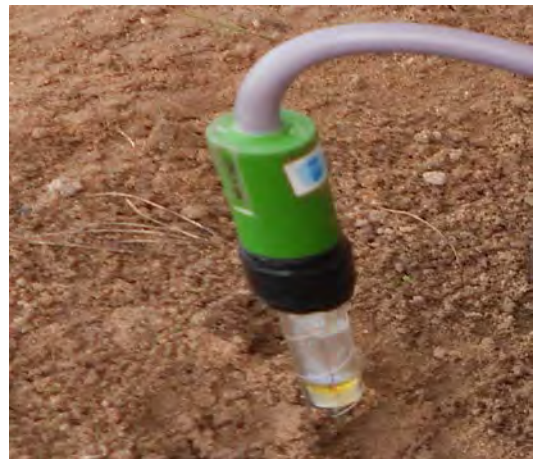
Hình 1.2.22. Cắm đầu điện cực vào trong lỗ
