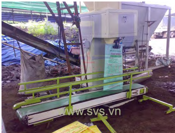
Hình 1.3.6. Cấu tạo cân đóng bao
